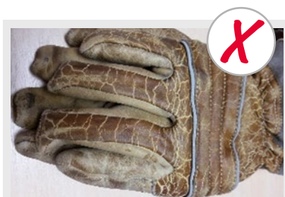
Wasch- und Brandschaden
